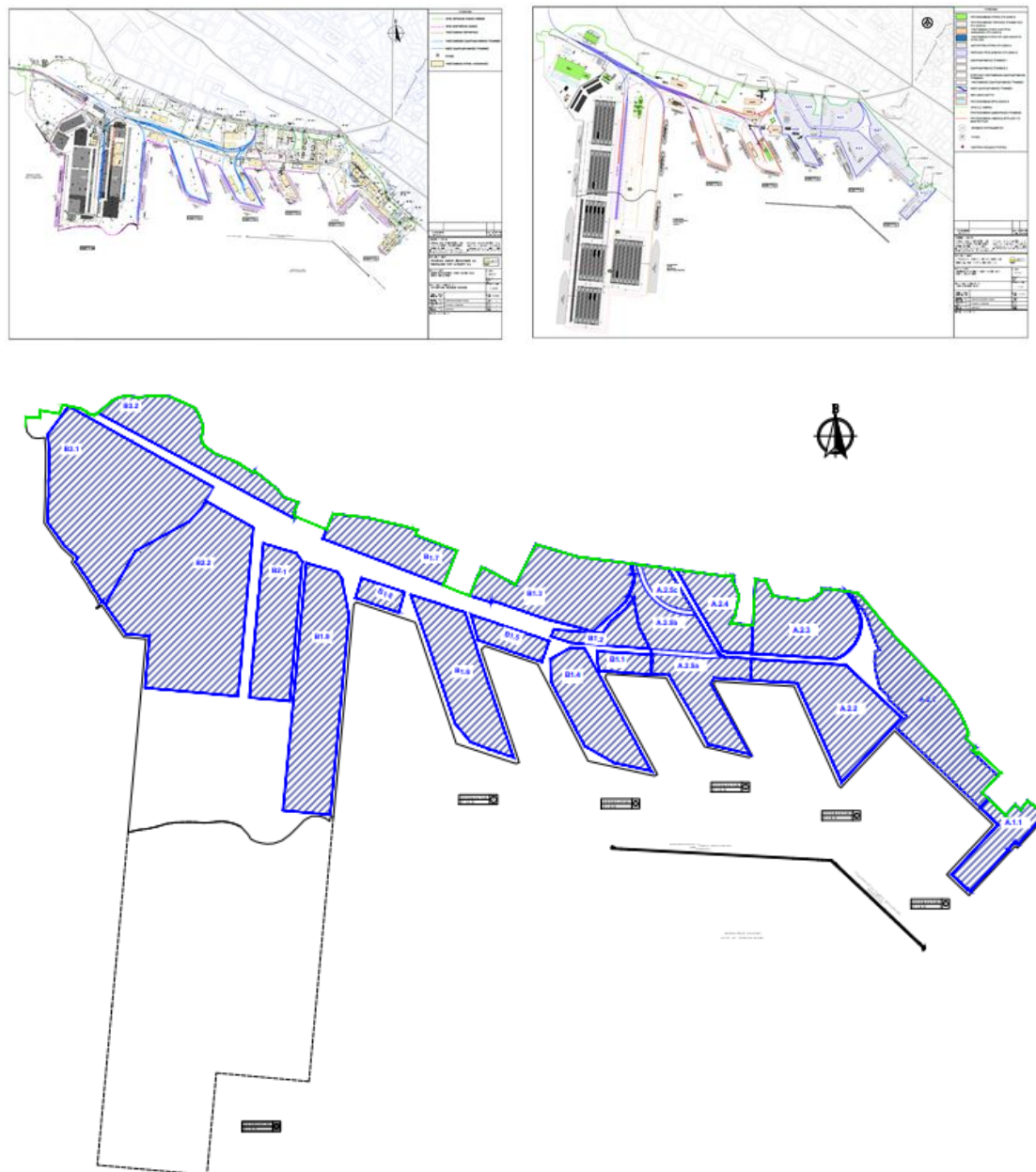
Σχήμα 14: Οριζοντιογραφίες υφιστάμενης κατάστασης (αριστερά) και προτεινόμενων έργων (δεξιά). Κάτοψη Προτεινόμενων περιοχών προς Δόμηση (κάτω)
